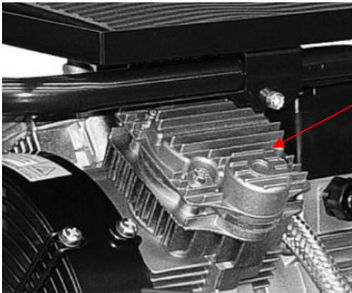
Luftfiltereinsatz sitzt an unter dem Zylinderkopf
