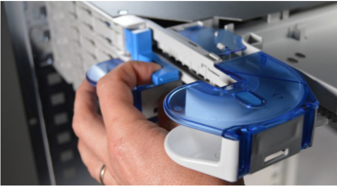
5.2.1. Schublade öffnen und beide Entriegelungshebel nach vorn ziehen.
