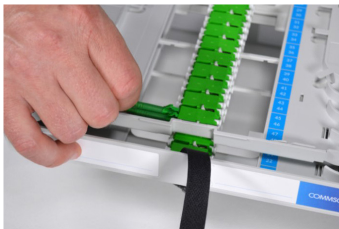
6.2. Klettband öffnen, Staubschutzkappe der Kupplung entfernen, Stecker des Patchkabels reinigen und Verbindung herstellen.
