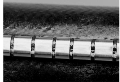
**2.23** bei ausreichender Wärmezufuhr werden in den Schienenschlitz zwei parallel verlaufende weisse Linien sichtbar.
