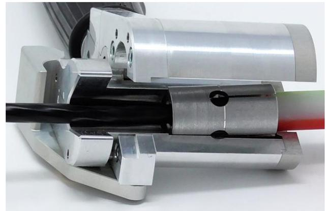
4.3 WGT in die Montagezange einlegen und die Montagezange schließen. Das Kabel zeigt nach oben, das Mikrorohr nach unten aus der Montagezange. Sollte die Montagezange nicht vollständig schließen, ist der WGT falsch eingelegt.
