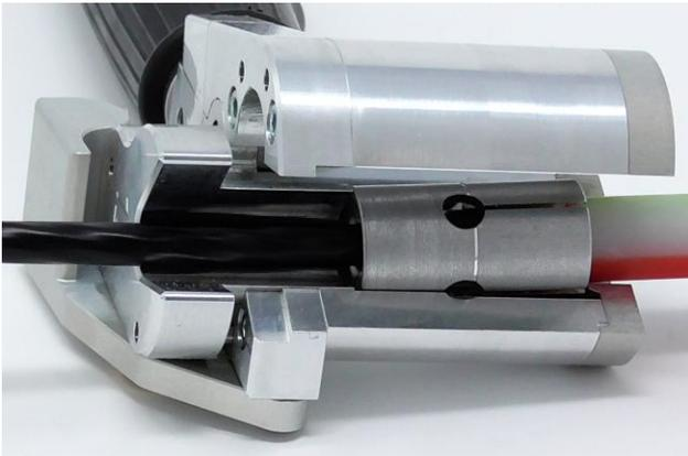
5.1 WGT in die Montagezange einlegen und die Montagezange schließen. Das Kabel zeigt nach oben, das Mikrorohr nach unten aus der Montagezange. Sollte die Montagezange nicht vollständig schließen, ist der WGT falsch eingelegt.
