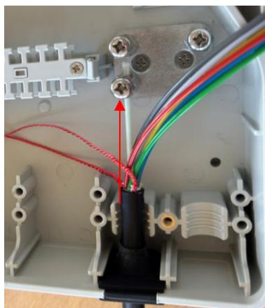
1. Das abgesetzte Kabel mit der Dichtung von oben in den Port schieben, bis es leicht einrastet.
