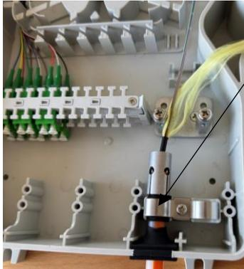
Das Mikrorohr mit dem Abfangbügel befestigen.
