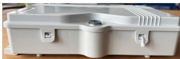
Den Deckel schließen und die seitlichen Laschen einrasten lassen. Anschließend die Box mit dem mitgelieferten Schlüssel verriegeln.
