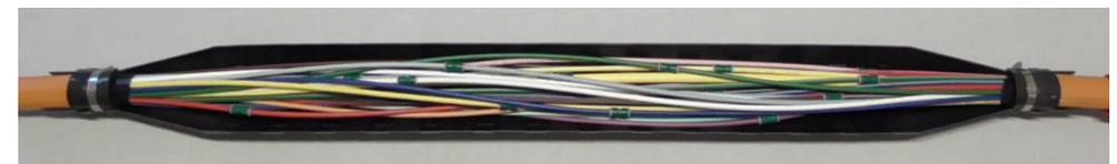
1.16 Die Bilder zeigen den fertig montierten Verbindungsschutz mit beiden Zugentlastungen.
