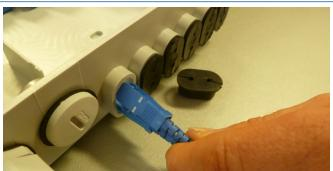
Anschliessend die Zugentlastungsleiste wieder montieren. Hierbei darauf achten, dass die Kabel exakt positioniert sind und die Verschluss-schrauben nur so fest anziehen, dass die Kabel nicht gequetscht werden.
