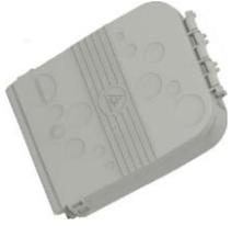
Wandmontierbare Glasfaser-Abschlussbox mit 2x LC/APC (Duplex) Adaptern und 4x Pigtails LC/APC DIN Farbcode, 2x Pigtail LC/APC weiß. Zuleitungskabel kann je nach Kabeldurchmesser bis zu 50 m in der Box aufgewickelt werden.
